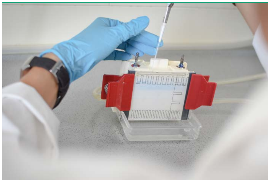
■ Abb. 4: Untersuchung der Reinheit einer Proteinprobe zur Qualitätskontrolle mittels Natrium-Dodecylsulfat-Polyacrylamid-Gelelektrophorese (Foto: Jürgen Rennecke).
