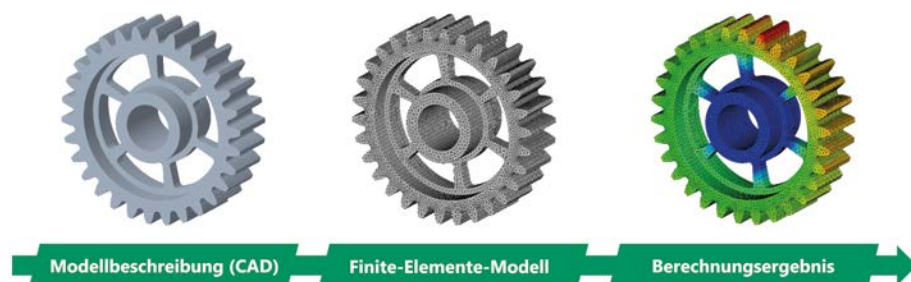
■ Abb. 7 (unten): Aljoscha Zahn M.Sc. berechnet die Verformung eines Zahnrad unter Belastung (Foto: Christian Wißler).
