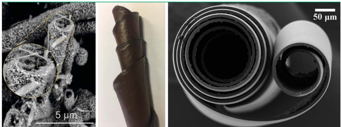
■ Abb. 7: Links: Bioinspirierte Cobalthydroxidcarbonat-Strukturen. Eine Abscheidung in Gegenwart von Tabakmosaikviren führt zu Mikroröhrchen, die aus einem bioanorganischen Kompositmaterial bestehen. Im gelben Kreis: Vergrößerte Darstellung des Querschnitts eines Mikroröhrchens und Vergleich mit den Dimensionen eines einzelnen Virus-Partikels 6 . Mitte: Selbstaufrollung als biologisches Phänomen: spiralisierte Struktur einer Schote. Rechts: Rasterelektronen-mikroskopische Aufnahme eines selbstaufgerollten \text{Co}_3\text{O}_4 -Films 6 (Bilder: Anna Schenk & Viktoria Grün).
