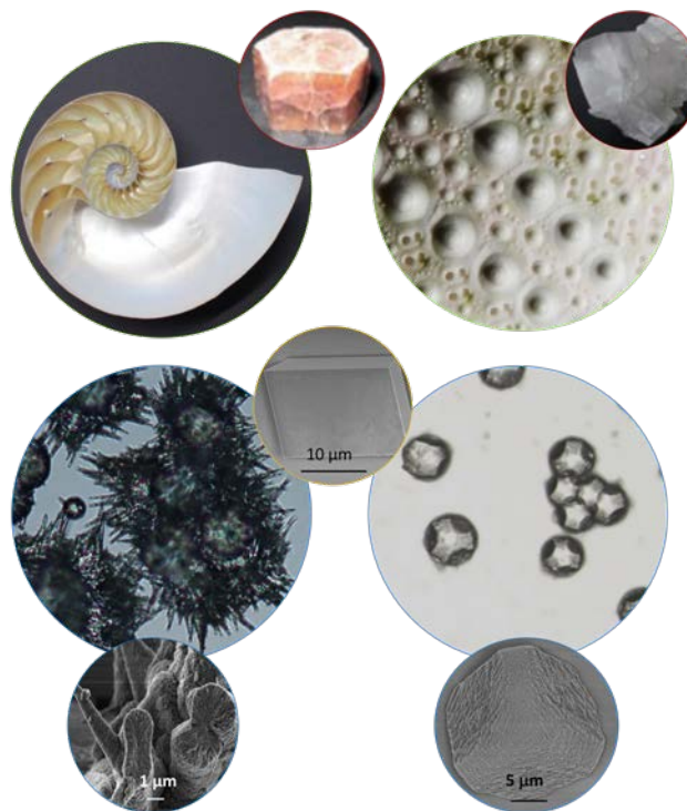
■ Abb. 1: Geologische, biogene und synthetische Calciumcarbonat-Strukturen. Oben links: Nautilus-Schale mit glänzender Perlmutter-Schicht, die aus Aragonit besteht; anbei ein geologischer Aragonitkristall. Aragonit ist eine der drei in der Natur vorkommenden wasserfreien kristallinen Modifikationen von Calciumcarbonat. – Oben rechts: Seeigelskelett, das aus einer porösen Calcitstruktur besteht; anbei ein geologischer Calcitkristall. – Mitte: Synthetisch hergestellter Calcit-Einkristall. – Unten: Bioinspirierte Calcitpartikel mit ungewöhnlichen Morphologien, die durch Kristallisation in Gegenwart von Polyvinylamin (links) 2 und von Polysyrolsulfonat (rechts) 3 entstehen (Bilder: Anna Schenk).
